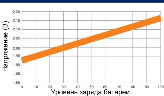
Зависимость напряжения от уровня заряда (20°C)
